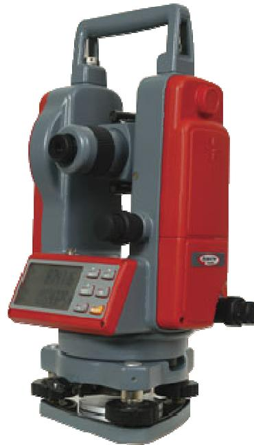
Diseñado para aplicaciones generales de construcción. Uso muy sencillo y alta precisión (2"- 0.6mgon).
